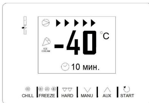
**НАГРЕВАНИЕ ИГОЛЬЧАТОГО ЩУПА** - применяется при циклах с контролем температуры. Цикл запускается только при открытой двери изделия, после запуска цикла дверь можно закрыть.
