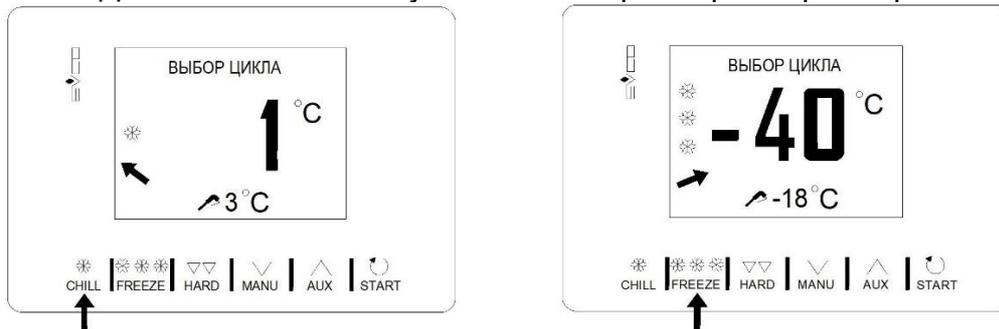
Для переключения из режима с управлением по температуре в режим с управлением по времени нажмите еще раз кнопку **❄️ CHILL** или **❄️❄️❄️ FREEZE**. Цикл может быть в любой момент остановлен, для этого в течение 2 секунд нажимайте кнопку **START**. Пример цикла шоковой заморозки, управляемого по температуре (с игольчатым щупом) - преобразование в цикл с управлением по времени и запуск цикла.
