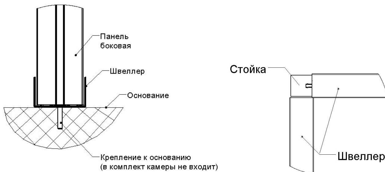
Рис.1а Установка панелей на швеллер
