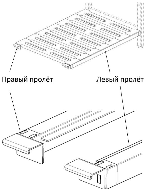
10. Для монтажа углового зацепа предварительно установите его в паз торца пролёта полки максимально глубоко. Далее, оперев на твердую поверхность и используя киянку с амортизирующим покрытием, осадите зацеп о конца. Повторите эту процедуру со всеми пролётами углового стеллажа.
