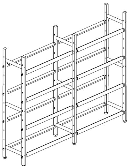
6. Выставить стеллаж по уровню, используя винтовые опоры. При необходимости закрепить стеллаж к стене, используя кронштейны.
