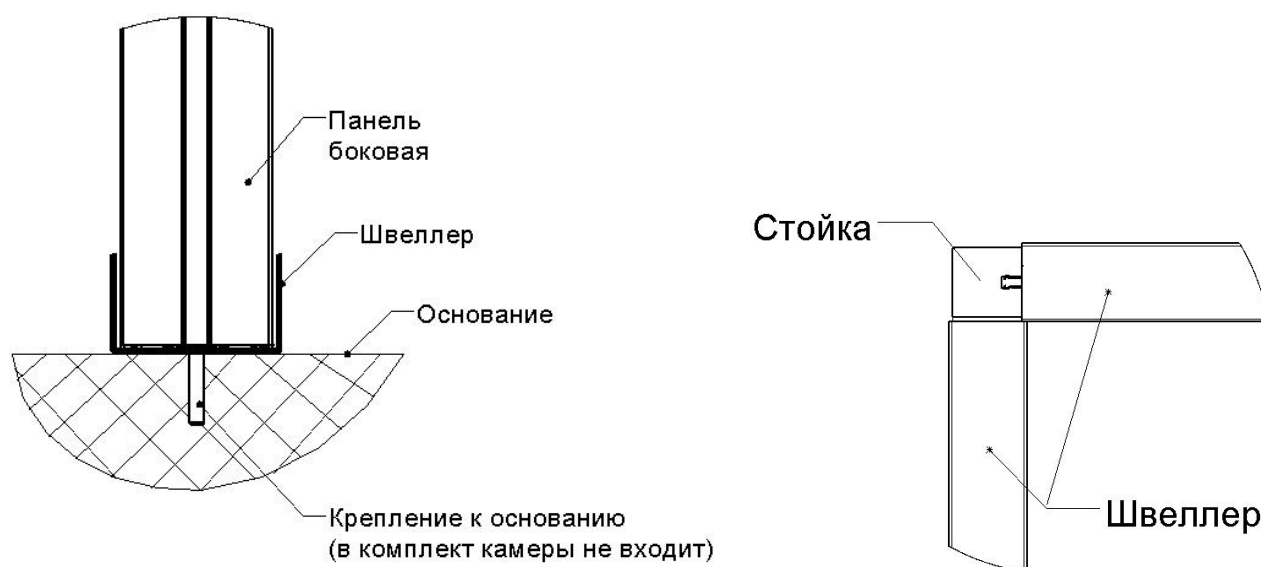
Рис.1а Установка панелей на швеллер
