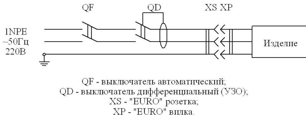
Рис. 1. Схема подключения изделия к электросети
