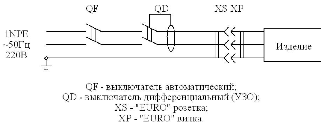
Рис. 1. Схема подключения изделия к электросети.
