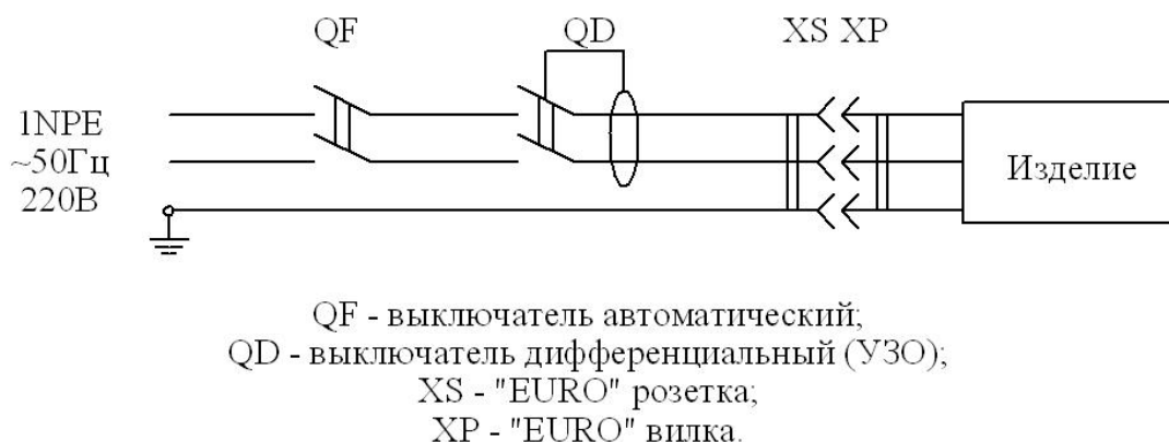
Рис. 1. Схема подключения изделия к электросети
