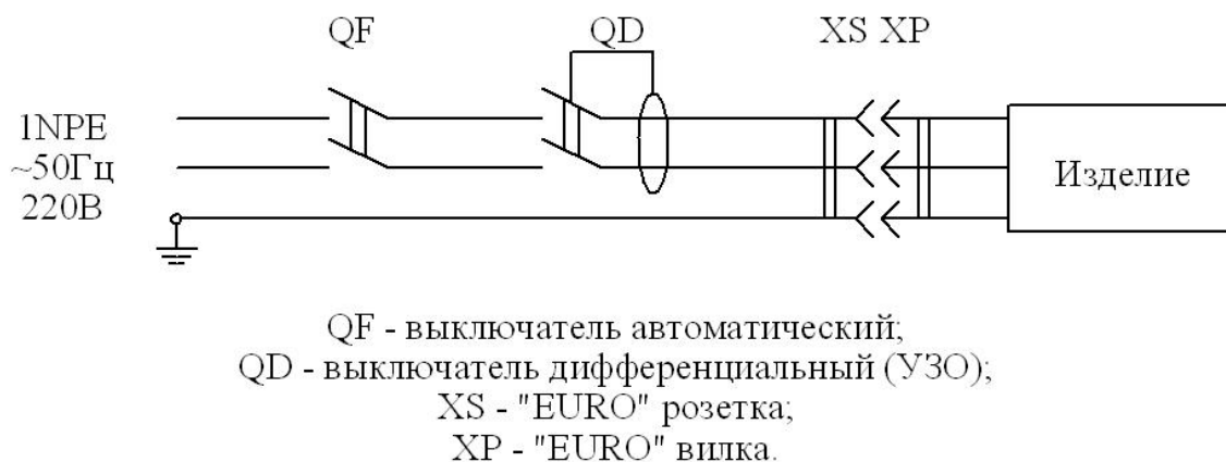
Рис. 1. Схема подключения изделия к электросети.
