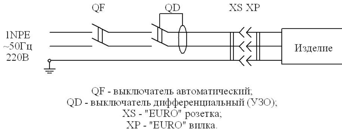
Рис. 1. Схема подключения изделия к электросети.
