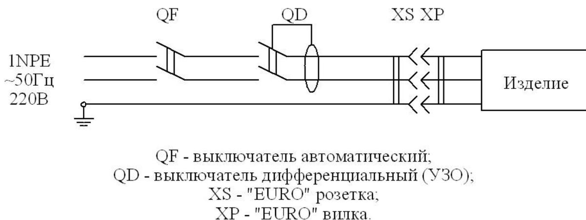
Рис. 1. Схема подключения изделия к электросети
